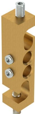
Abrazadera de conexión doble para el alojamiento de 2 cables del conductor para crear la conexión equipotencial de protección en sistemas portacables. Sirve como intersección para derivaciones y cruces. Montaje en cable del conductor, en mitad del muelle de apriete.
