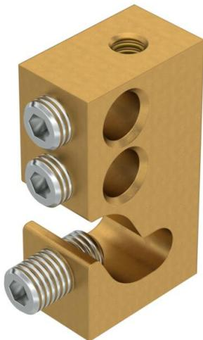
Abrazadera de conexión sencilla para el alojamiento de 1 cable del conductor, para crear la conexión equipotencial de protección en sistemas portacables. Adecuado para el montaje directo debajo de la bandeja portacables con tornillo de cabeza avellanada, tipo FKS M6x12. Cable conductor hasta máx. 35 mm<sup>2</sup>, casquillo recomendado entre 6 mm<sup>2</sup> y 35 mm<sup>2</sup> según DIN 46228, parte 4, longitud de aislamiento de 18 mm.
