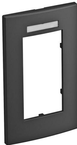
Tapa de fijación frontal para mecanismos Modul 45, doble, con campo identificativo, para la instalación vertical de mecanismos, se encaja en la caja portamecanismos 71GD13 o en el soporte de montaje 71MT2 45.
