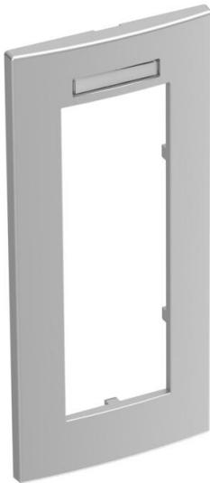
Tapa de fijación frontal para mecanismos Modul 45, triple, con campo identificativo, para la instalación vertical de mecanismos, se encaja en la caja portamecanismos 71GD9-2 o en el soporte de montaje 71MT3 45-2.
