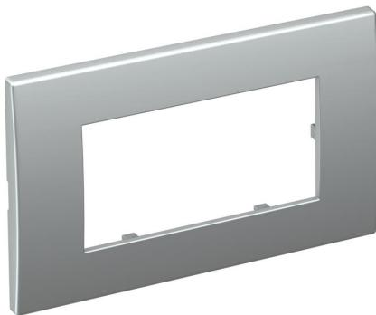
Tapa de fijación frontal para mecanismos Modul 45, doble, sin campo identificativo, para la instalación horizontal y vertical de mecanismos, se encaja en la caja portamecanismos 71GD13 o el soporte de montaje 71MT2 45. Para la instalación en canales portamecanismos Rapid 80 y columnas de instalación eléctrica ISS.
