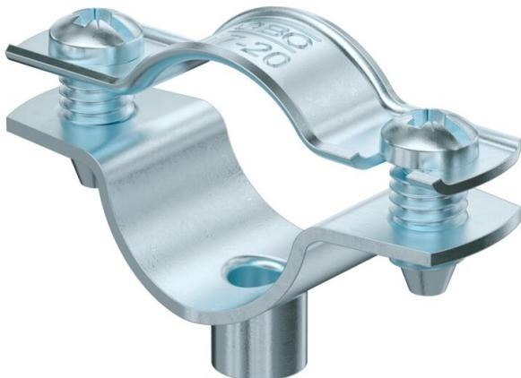
Abrazadera para el montaje de tubos y cables en la pared, el techo y el suelo. Con tapa autoblocante. Fijación a través de inserción con rosca interior. Testado y aprobado para el mantenimiento de funciones según DIN 4102 Parte 12, clases de mantenimiento de funciones E 30 a E 90.
