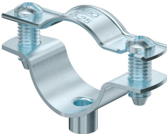
Abrazadera para el montaje de tubos y cables en la pared, el techo y el suelo. Con tapa autoblocante. Fijación a través de inserción con rosca interior. Testado y aprobado para el mantenimiento de funciones según DIN 4102 Parte 12, clases de mantenimiento de funciones E 30 a E 90.
