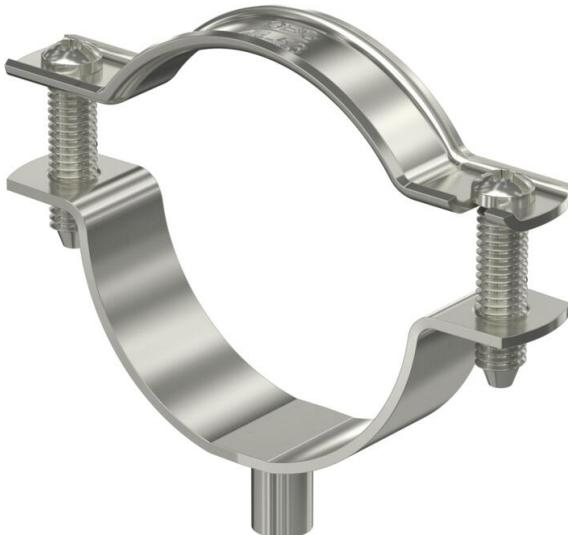
Abrazadera para el montaje de tubos y cables en la pared, el techo y el suelo. Con tapa autoblocante. Fijación a través de inserción con rosca interior. Superficies G y T a partir de tamaño de abrazadera 20 apropiado para el montaje con pistolas clavadoras y pistolas de pernos.
