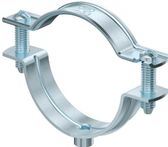
Abrazadera para el montaje de tubos y cables en la pared, el techo y el suelo. Con tapa autoblocante. Fijación a través de inserción con rosca interior. Testado y aprobado para el mantenimiento de funciones según DIN 4102 Parte 12, clases de mantenimiento de funciones E 30 a E 90.
