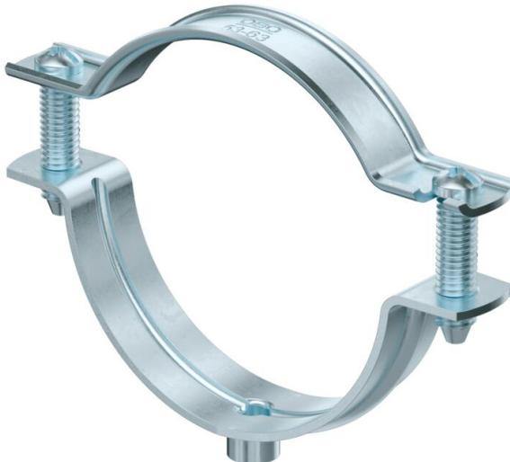
Abrazadera para el montaje de tubos y cables en la pared, el techo y el suelo. Con tapa autoblocante. Fijación a través de inserción con rosca interior. Testado y aprobado para el mantenimiento de funciones según DIN 4102 Parte 12, clases de mantenimiento de funciones E 30 a E 90.
