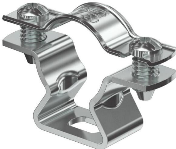
Abrazadera para el montaje de tubos y cables en la pared, el techo y el suelo. Con tapa autoblocante. Fijación a través de agujero alargado. A partir de tamaño de abrazadera 20 apropiado para el montaje con pistolas clavadoras y pistolas de pernos.
