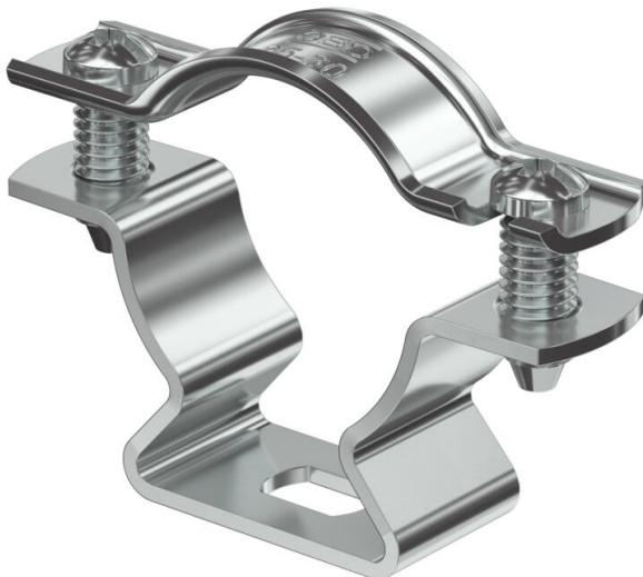
Abrazadera para el montaje de tubos y cables en la pared, el techo y el suelo. Con tapa autoblocante. Fijación a través de agujero alargado. A partir de tamaño de abrazadera 20 apropiado para el montaje con pistolas clavadoras y pistolas de pernos.
