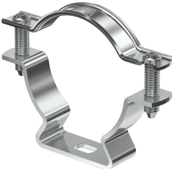
Abrazadera para el montaje de tubos y cables en la pared, el techo y el suelo. Con tapa autoblocante. Fijación a través de agujero alargado. A partir de tamaño de abrazadera 20 apropiado para el montaje con pistolas clavadoras y pistolas de pernos.
