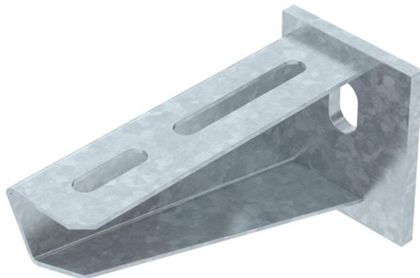
Escuadra de pared/perfil de cargas medias con cabeza para perfil soldada. Fijación de la escuadra en el perfil en U a partir de un ancho de 400 mm usando tornillo de cabeza hexagonal a ambos lados del soporte. Utilice para ello la pieza distanciadora adecuada.
