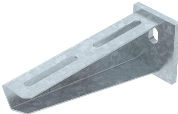
Escuadra de pared/perfil de cargas medias con cabeza para perfil soldada. Fijación de la escuadra en el perfil en U a partir de un ancho de 400 mm usando tornillo de cabeza hexagonal a ambos lados del soporte. Utilice para ello la pieza distanciadora adecuada.
