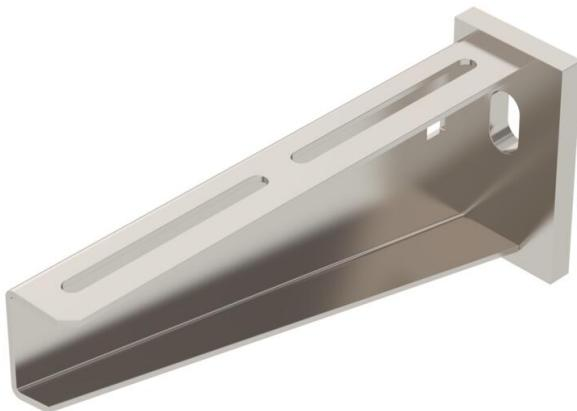
Escuadra de pared/perfil para cargas pesadas con cabeza para perfil soldada. Fijación de la escuadra en el perfil en U a partir de un ancho de 400 mm usando tornillo de cabeza hexagonal a ambos lados del soporte. Utilice para ello la pieza distanciadora adecuada.
