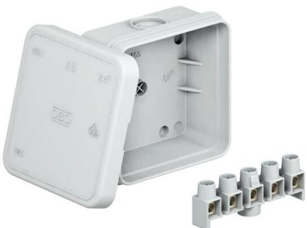
Grado de protección IP55, tensión nominal de 690 V, sección nominal de 2,5 mm<sup>2</sup>, 7 entradas para diámetro de cable de 5-14 mm.
