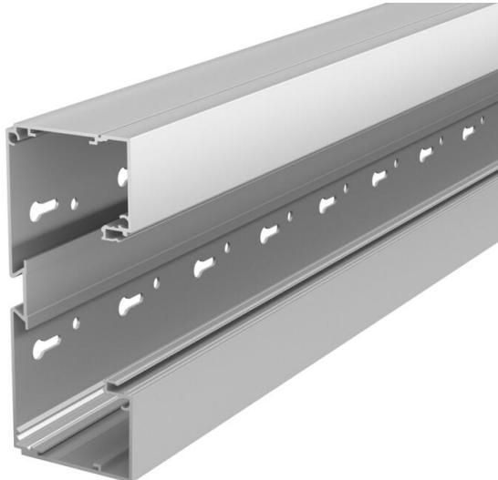
Canal portamecanismos con perforación en el suelo apto para montaje en pared directo o sobre consolas. Se pueden suministrar otros colores RAL bajo demanda. Las superficies visibles de los canales portamecanismos están laminadas. La tapa se debe pedir por separado.
