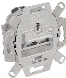
UAE Cat. 6 A ISO 8/8 Toma de luz con anillo de soporte separable para versión barra. 2 conexiones. Cumple las máximas exigencias de producto de técnica de transmisión según ISO/IEC 11 801:2011-06 para ancho de banda 500 MHz (10 Gbit/s). La placa central no está incluida en el volumen de suministro y debe pedirse por separado.
