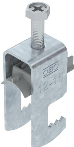
Abrazadera sobre perfil con base F, mediacaña de plástico de polipropileno. Para el montaje vertical y horizontal de 1 cable individual en perfiles planos. Con tornillo de 1 paso en la mediacaña, cabeza de tornillo hexagonal universal SW10, con ranura y ranura en cruz. Adecuado para montaje en zonas interiores y exteriores. Se recomienda el uso de una contra-caña.
