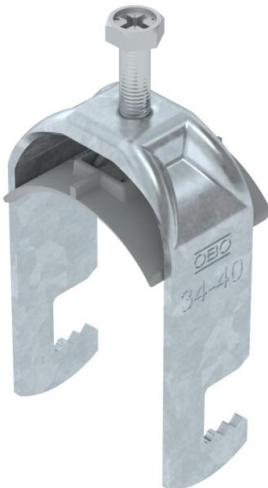
Abrazadera sobre perfil con base F, mediacaña de plástico de polipropileno. Para el montaje vertical y horizontal de 1 cable individual en perfiles planos. Con tornillo de 1 paso en la mediacaña, cabeza de tornillo hexagonal universal SW10, con ranura y ranura en cruz. Adecuado para montaje en zonas interiores y exteriores. Se recomienda el uso de una contra-caña.
