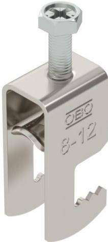
Abrazadera sobre perfil con base F, mediacaña metálica con bordes redondeados para proteger los cables. Para el montaje vertical y horizontal de 1 cable individual en perfiles planos. Con tornillo de 1 paso en la mediacaña, cabeza de tornillo hexagonal universal SW10, con ranura y ranura en cruz. Adecuado para montaje en zonas interiores y exteriores. Se recomienda el uso de una contracaña.
