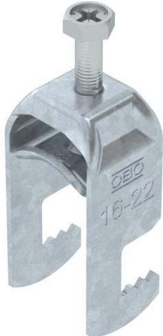
Abrazadera sobre perfil con base F, mediacaña metálica con bordes redondeados para proteger los cables. Para el montaje vertical y horizontal de 1 cable individual en perfiles planos. Con tornillo de 1 paso en la mediacaña, cabeza de tornillo hexagonal universal SW10, con ranura y ranura en cruz. Adecuado para montaje en zonas interiores y exteriores. Se recomienda el uso de una contra-caña.
