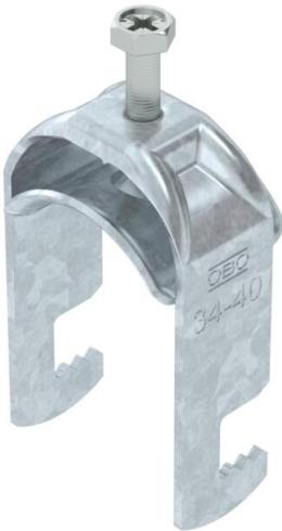
Abrazadera sobre perfil con base F, mediacaña metálica con bordes redondeados para proteger los cables. Para el montaje vertical y horizontal de 1 cable individual en perfiles planos. Con tornillo de 1 paso en la mediacaña, cabeza de tornillo hexagonal universal SW10, con ranura y ranura en cruz. Adecuado para montaje en zonas interiores y exteriores. Se recomienda el uso de una contra-caña.
