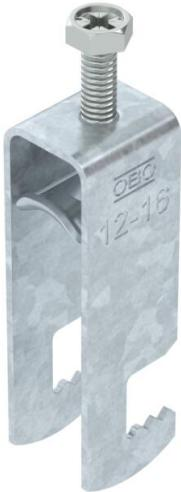
Abrazadera sobre perfil con base F, mediacaña metálica con bordes redondeados para proteger los cables. Para el montaje vertical y horizontal de 2 cables individuales en perfiles planos. Con tornillo de 1 paso en la mediacaña, cabeza de tornillo hexagonal universal SW10, con ranura y ranura en cruz. Adecuado para montaje en zonas interiores y exteriores. Es conveniente separar varios cables mediante cañas dobles. Se recomienda el uso de una contra-caña.
