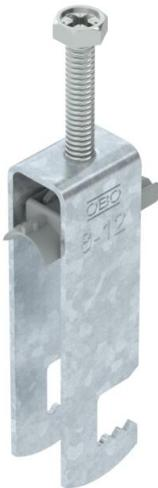
Abrazadera sobre perfil con base F, mediacaña de plástico de polipropileno. Para el montaje vertical y horizontal de 3 cables individuales en barras planas. Con tornillo de 1 paso en la mediacaña, cabeza de tornillo hexagonal universal SW10, con ranura y ranura en cruz. Adecuado para montaje en zonas interiores y exteriores. Es conveniente separar varios cables mediante cañas dobles. Se recomienda el uso de una contra-caña.
