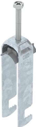
Abrazadera sobre perfil con base F, mediacaña de plástico de polipropileno. Para el montaje vertical y horizontal de 3 cables individuales en barras planas. Con tornillo de 1 paso en la mediacaña, cabeza de tornillo hexagonal universal SW10, con ranura y ranura en cruz. Adecuado para montaje en zonas interiores y exteriores. Es conveniente separar varios cables mediante cañas dobles. Se recomienda el uso de una contra-caña.
