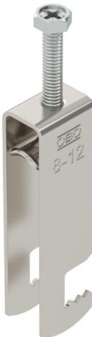
Abrazadera sobre perfil con base F, mediacaña metálica con bordes redondeados para proteger los cables. Para el montaje vertical y horizontal de 3 cables individuales en barras planas. Con tornillo de 1 paso en la mediacaña, cabeza de tornillo hexagonal universal SW10, con ranura y ranura en cruz. Adecuado para montaje en zonas interiores y exteriores. Es conveniente separar varios cables mediante cañas dobles. Se recomienda el uso de una contra-caña.
