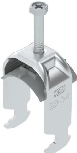
Abrazadera sobre perfil con base con cabeza de martillo, mediacaña de plástico de polipropileno. Para el montaje vertical y horizontal de 1 cable individual en perfil tipo C. Para ancho de ranura de 16 - 17 mm. Con tornillo de 1 paso en la mediacaña, cabeza de tornillo hexagonal universal SW10, con ranura y ranura en cruz. Adecuado para montaje en zonas interiores y exteriores. Se recomienda el uso de una contra-caña.
