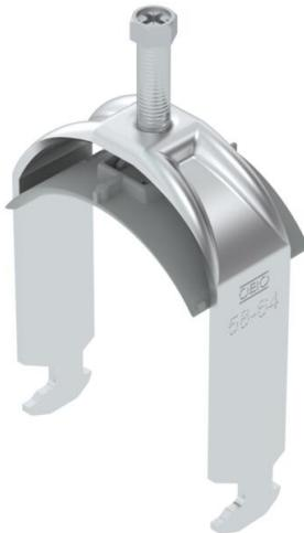
Abrazadera sobre perfil con base con cabeza de martillo, mediacaña de plástico de polipropileno. Para el montaje vertical y horizontal de 1 cable individual en perfil tipo C. Para ancho de ranura de 16 - 17 mm. Con tornillo de 1 paso en la mediacaña, cabeza de tornillo hexagonal universal SW10, con ranura y ranura en cruz. Adecuado para montaje en zonas interiores y exteriores. Se recomienda el uso de una contra-caña.
