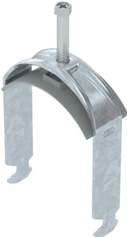
Abrazadera sobre perfil con base con cabeza de martillo, mediacaña de plástico de polipropileno. Para el montaje vertical y horizontal de 1 cable individual en perfil tipo C. Para ancho de ranura de 16 - 17 mm. Con tornillo de 1 paso en la mediacaña, cabeza de tornillo hexagonal universal SW10, con ranura y ranura en cruz. Adecuado para montaje en zonas interiores y exteriores. Se recomienda el uso de una contra-caña.
