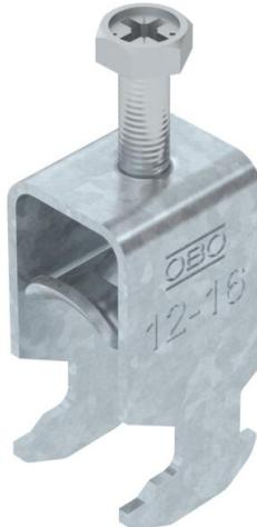
Abrazadera sobre perfil con base con cabeza de martillo, mediacaña metálica con bordes redondeados para proteger los cables. Para el montaje vertical y horizontal de 1 cable individual en perfil tipo C. Para ancho de ranura de 16 - 17 mm. Con tornillo de 1 paso en la mediacaña, cabeza de tornillo hexagonal universal SW10, con ranura y ranura en cruz. Adecuado para montaje en zonas interiores y exteriores. La contracaña se debe pedir por separado.
