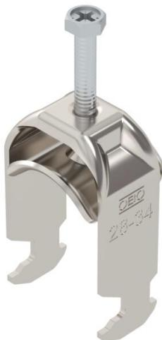
Abrazadera sobre perfil con base con cabeza de martillo, mediacaña metálica con bordes redondeados para proteger los cables. Para el montaje vertical y horizontal de 1 cable individual en perfil tipo C. Para ancho de ranura de 16 - 17 mm. Con tornillo de 1 paso en la mediacaña, cabeza de tornillo hexagonal universal SW10, con ranura y ranura en cruz. Adecuado para montaje en zonas interiores y exteriores. Se recomienda el uso de una contra-caña.
