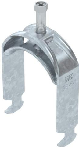
Abrazadera sobre perfil con base con cabeza de martillo, mediacaña metálica con bordes redondeados para proteger los cables. Para el montaje vertical y horizontal de 1 cable individual en perfil tipo C. Para ancho de ranura de 16 - 17 mm. Con tornillo de 1 paso en la mediacaña, cabeza de tornillo hexagonal universal SW10, con ranura y ranura en cruz. Adecuado para montaje en zonas interiores y exteriores. La contracaña se debe pedir por separado.
