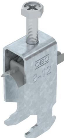
Abrazadera sobre perfil con base con cabeza de martillo, mediacaña de plástico de polipropileno. Para el montaje vertical y horizontal de 2 cables individuales en perfil tipo C. Para ancho de ranura de 16 - 17 mm. Con tornillo de 1 paso en la mediacaña, cabeza de tornillo hexagonal universal SW10, con ranura y ranura en cruz. Adecuado para montaje en zonas interiores y exteriores. Es conveniente separar varios cables mediante cañas dobles. Se recomienda el uso de una contra-caña.
