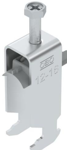
Abrazadera sobre perfil con base con cabeza de martillo, mediacaña de plástico de polipropileno. Para el montaje vertical y horizontal de 2 cables individuales en perfil tipo C. Para ancho de ranura de 16 - 17 mm. Con tornillo de 1 paso en la mediacaña, cabeza de tornillo hexagonal universal SW10, con ranura y ranura en cruz. Adecuado para montaje en zonas interiores y exteriores. Es conveniente separar varios cables mediante cañas dobles. Se recomienda el uso de una contra-caña.
