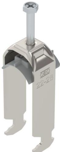
Abrazadera sobre perfil con base con cabeza de martillo, mediacaña de plástico de polipropileno. Para el montaje vertical y horizontal de 2 cables individuales en perfil tipo C. Para ancho de ranura de 16 - 17 mm. Con tornillo de 1 paso en la mediacaña, cabeza de tornillo hexagonal universal SW10, con ranura y ranura en cruz. Adecuado para montaje en zonas interiores y exteriores. Es conveniente separar varios cables mediante cañas dobles. Se recomienda el uso de una contra-caña.
