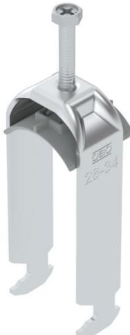
Abrazadera sobre perfil con base con cabeza de martillo, mediacaña de plástico de polipropileno. Para el montaje vertical y horizontal de 2 cables individuales en perfil tipo C. Para ancho de ranura de 16 - 17 mm. Con tornillo de 1 paso en la mediacaña, cabeza de tornillo hexagonal universal SW10, con ranura y ranura en cruz. Adecuado para montaje en zonas interiores y exteriores. Es conveniente separar varios cables mediante cañas dobles. Se recomienda el uso de una contra-caña.
