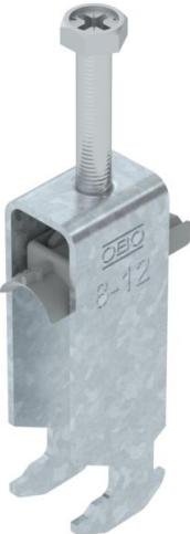
Abrazadera sobre perfil con base con cabeza de martillo, mediacaña de plástico de polipropileno. Para el montaje vertical y horizontal de 3 cables individuales en perfil tipo C. Para ancho de ranura de 16 - 17 mm. Con tornillo de 1 paso en la mediacaña, cabeza de tornillo hexagonal universal SW10, con ranura y ranura en cruz. Adecuado para montaje en zonas interiores y exteriores. Es conveniente separar varios cables mediante cañas dobles. Se recomienda el uso de una contra-caña.
