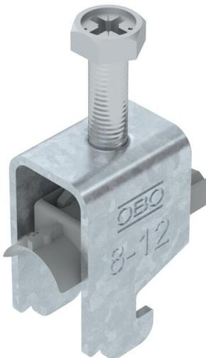
Abrazadera sobre perfil con base N, mediacaña de plástico de polipropileno. Para el montaje vertical y horizontal de 1 cable individual en perfil tipo C. Para ancho de ranura de 11 - 12 mm. Con tornillo de 1 paso en la mediacaña, cabeza de tornillo hexagonal universal SW10, con ranura y ranura en cruz. Adecuado para montaje en zonas interiores y exteriores. Se recomienda el uso de una contra-caña.
