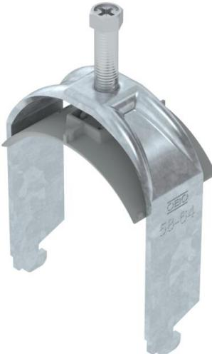
Abrazadera sobre perfil con base N, mediacaña de plástico de polipropileno. Para el montaje vertical y horizontal de 1 cable individual en perfil tipo C. Para ancho de ranura de 11 - 12 mm. Con tornillo de 1 paso en la mediacaña, cabeza de tornillo hexagonal universal SW10, con ranura y ranura en cruz. Adecuado para montaje en zonas interiores y exteriores. Se recomienda el uso de una contra-caña.
