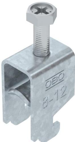
Abrazadera sobre perfil con base N, mediacaña metálica con bordes redondeados para proteger los cables. Para el montaje vertical y horizontal de 1 cable individual en perfil tipo C. Para ancho de ranura de 11 - 12 mm. Con tornillo de 1 paso en la mediacaña, cabeza de tornillo hexagonal universal SW10, con ranura y ranura en cruz. Adecuado para montaje en zonas interiores y exteriores. Se recomienda el uso de una contra-caña.
