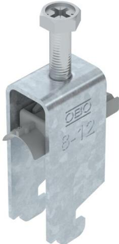
Abrazadera sobre perfil con base N, mediacaña de plástico de polipropileno. Para el montaje vertical y horizontal de 2 cables individuales en perfil tipo C. Para ancho de ranura de 11 - 12 mm. Con tornillo de 1 paso en la mediacaña, cabeza de tornillo hexagonal universal SW10, con ranura y ranura en cruz. Adecuado para montaje en zonas interiores y exteriores. Es conveniente separar varios cables mediante cañas dobles. Se recomienda el uso de una contra-caña.
