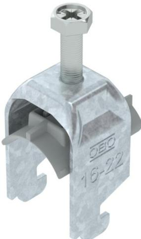
Abrazadera sobre perfil con base N, mediacaña de plástico de polipropileno. Para el montaje vertical y horizontal de 2 cables individuales en perfil tipo C. Para ancho de ranura de 11 - 12 mm. Con tornillo de 1 paso en la mediacaña, cabeza de tornillo hexagonal universal SW10, con ranura y ranura en cruz. Adecuado para montaje en zonas interiores y exteriores. Es conveniente separar varios cables mediante cañas dobles. Se recomienda el uso de una contra-caña.
