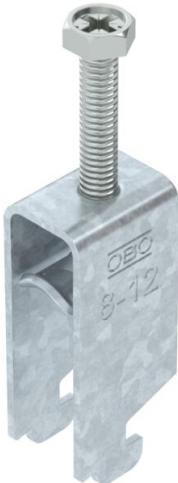
Abrazadera sobre perfil con base N, mediacaña metálica con bordes redondeados para proteger los cables. Para el montaje vertical y horizontal de 2 cables individuales en perfil tipo C. Para ancho de ranura de 11 - 12 mm. Con tornillo de 1 paso en la mediacaña, cabeza de tornillo hexagonal universal SW10, con ranura y ranura en cruz. Adecuado para montaje en zonas interiores y exteriores. Es conveniente separar varios cables mediante cañas dobles. Se recomienda el uso de una contra-caña.
