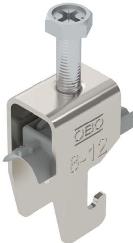
Abrazadera sobre perfil con base U, mediacaña de plástico de polipropileno. Para el montaje vertical y horizontal de 1 cable individual en perfil tipo C. Para ancho de ranura de 18 - 22 mm. Con tornillo de 1 paso en la mediacaña, cabeza de tornillo hexagonal universal SW10, con ranura y ranura en cruz. Adecuado para montaje en zonas interiores y exteriores. Se recomienda el uso de una contra-caña.
