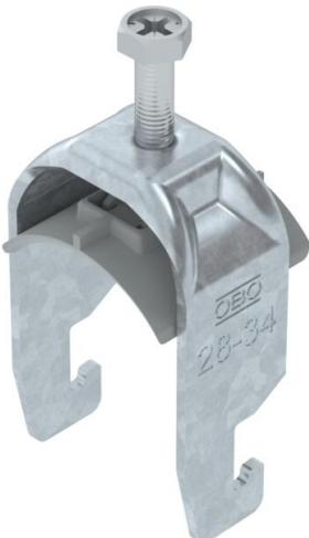
Abrazadera sobre perfil con base U, mediacaña de plástico de polipropileno. Para el montaje vertical y horizontal de 1 cable individual en perfil tipo C. Para ancho de ranura de 18 - 22 mm. Con tornillo de 1 paso en la mediacaña, cabeza de tornillo hexagonal universal SW10, con ranura y ranura en cruz. Adecuado para montaje en zonas interiores y exteriores. Se recomienda el uso de una contra-caña.
