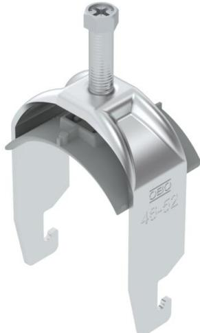
Abrazadera sobre perfil con base U, mediacaña de plástico de polipropileno. Para el montaje vertical y horizontal de 1 cable individual en perfil tipo C. Para ancho de ranura de 18 - 22 mm. Con tornillo de 1 paso en la mediacaña, cabeza de tornillo hexagonal universal SW10, con ranura y ranura en cruz. Adecuado para montaje en zonas interiores y exteriores. Se recomienda el uso de una contra-caña.
