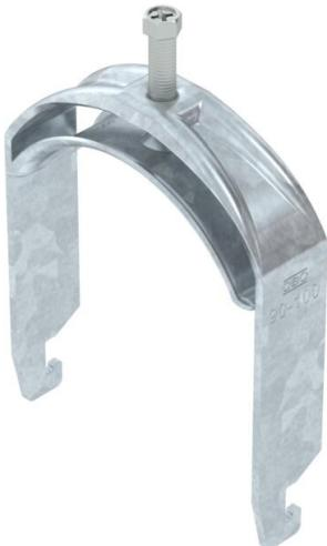
Abrazadera sobre perfil con base U, mediacaña metálica con bordes redondeados para proteger los cables. Para el montaje vertical y horizontal de 1 cable individual en perfil tipo C. Para ancho de ranura de 18 - 22 mm. Con tornillo de 1 paso en la mediacaña, cabeza de tornillo hexagonal universal SW10, con ranura y ranura en cruz. Adecuado para montaje en zonas interiores y exteriores. Se recomienda el uso de una contra-caña.
