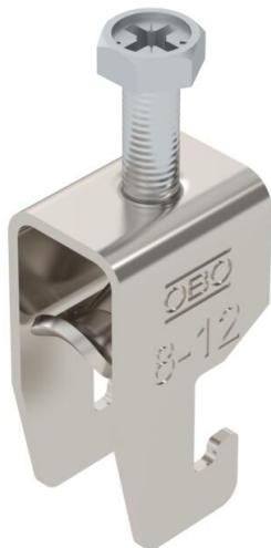
Abrazadera sobre perfil con base U, mediacaña metálica con bordes redondeados para proteger los cables. Para el montaje vertical y horizontal de 1 cable individual en perfil tipo C. Para ancho de ranura de 18 - 22 mm. Con tornillo de 1 paso en la mediacaña, cabeza de tornillo hexagonal universal SW10, con ranura y ranura en cruz. Adecuado para montaje en zonas interiores y exteriores. Se recomienda el uso de una contra-caña.
